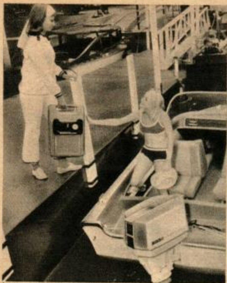
CHEZ CHRYSLER OUTBOARD , un réservoir ultra-léger en polyéthylène ; il pèse deux fois moins que les réservoirs ordinaires. Il est compris dans l'équipement standard de tous les moteurs Chrysler.
