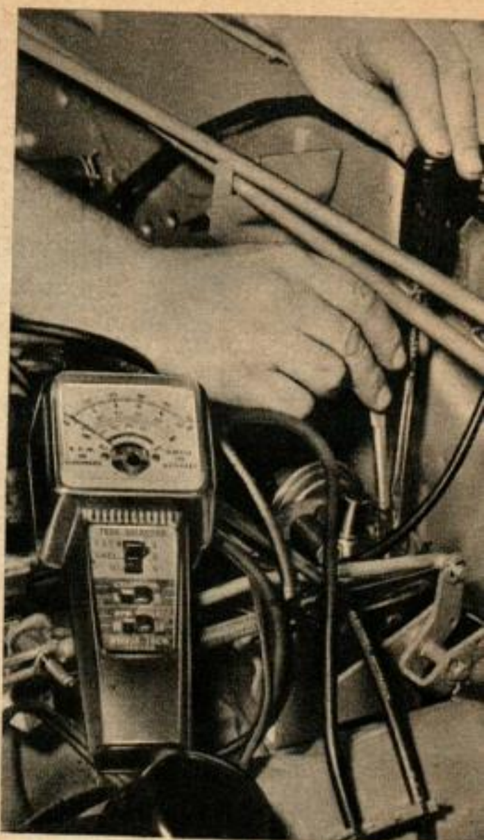
LE MOMENT DE L'ALLUMAGE vient du distributeur ; on voit ici le réglage de l'écartement des vis platinées et la vérification de l'angle de contact qui assure un bon allumage.
