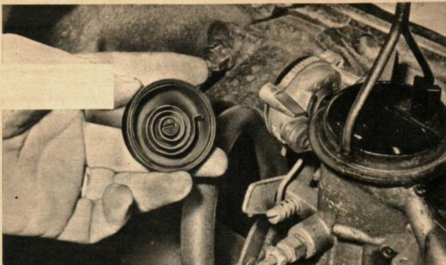
DANS LE STARTER monté sur le carburateur le ressort est logé dans le chapeau. Dans ce cas la valve est actionnée directement à travers le carburateur et non par une tige, comme dans le starter monté sur la tubulure.
