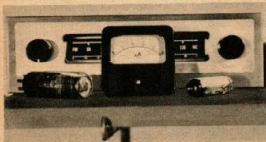
DEVANT L'« EICO HFT-90 » on voit trois indicateurs d'accord : de gauche à droite : tube 6E5, microampèremètre de 50 micro, et tube EM84. L'EM84 est le genre de tube utilisé sur certains postes de télévision en couleurs pour régler exactement le signal complexe de l'émission.
