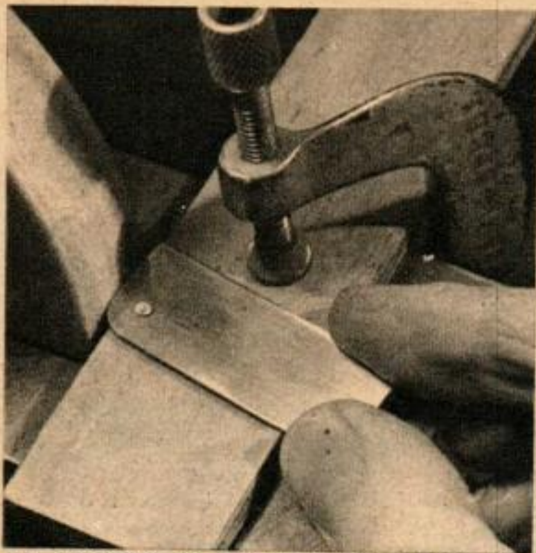
UN GABARIT DE RAYON se fait à l'aide d'un pivot. Une courbe rentrante sera percée et découpée.
