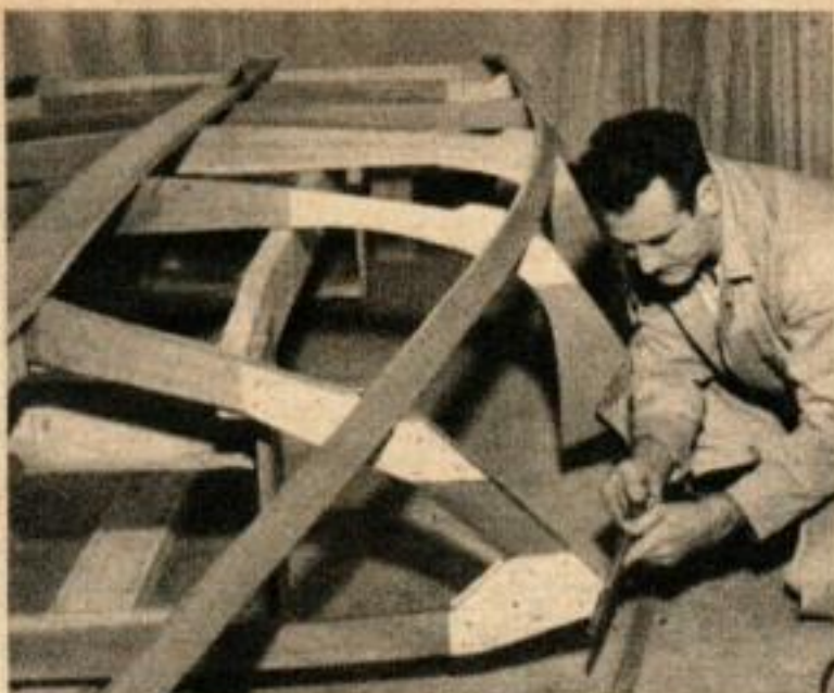
PRATIQUEZ DES ENTAILLES pour les membrures du plat-bord et du genou et biseautez-les pour que les lisses reposent bien une fois pliées.
