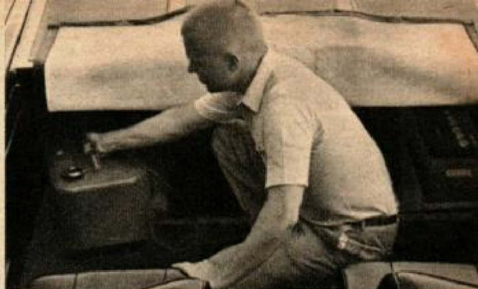
LE COMPARTIMENT DU MOTEUR est assez spacieux pour contenir la batterie et un réservoir qui s'ajoute à celui de 56 litres placé à l'avant. Une housse en vinyle va jusqu'au plancher.
