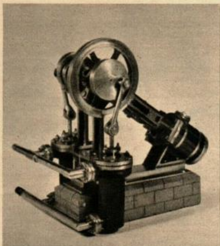
POMPE A CYLINDRE INCLINE , avec deux corps de pompe à simple effet actionnés par des excentriques montés sur l'arbre.
