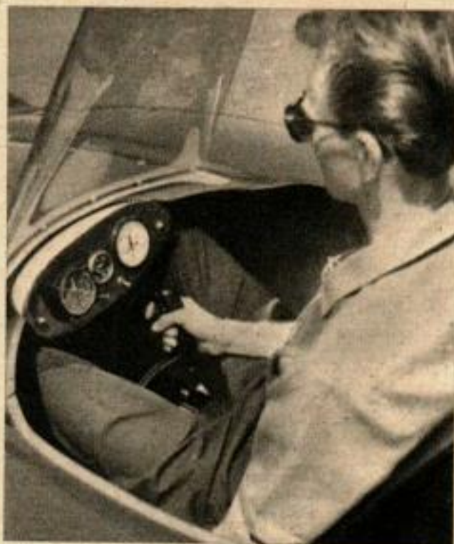
LE COCKPIT MONOPLACE est équipé des instruments et des commandes classiques y compris un manche à balai de commande, cyclique, et une commande collective gaz et pas d'hélice.
