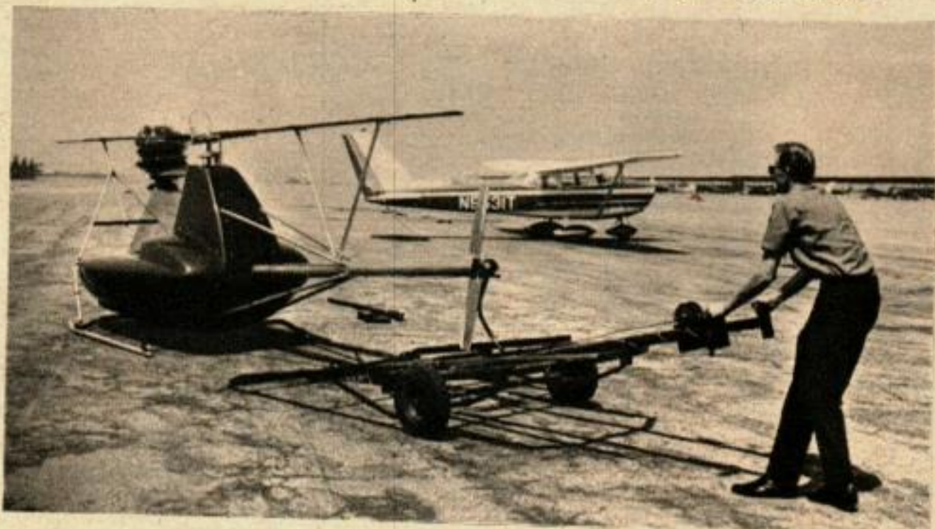
L'HELICOPTERE de Schramm pèse 230 kg et peut être déplacé facilement par un seul homme. Le moteur de 100 cv lui permet d'atteindre une vitesse de 160 km/h et une altitude de 3 600 m environ.
