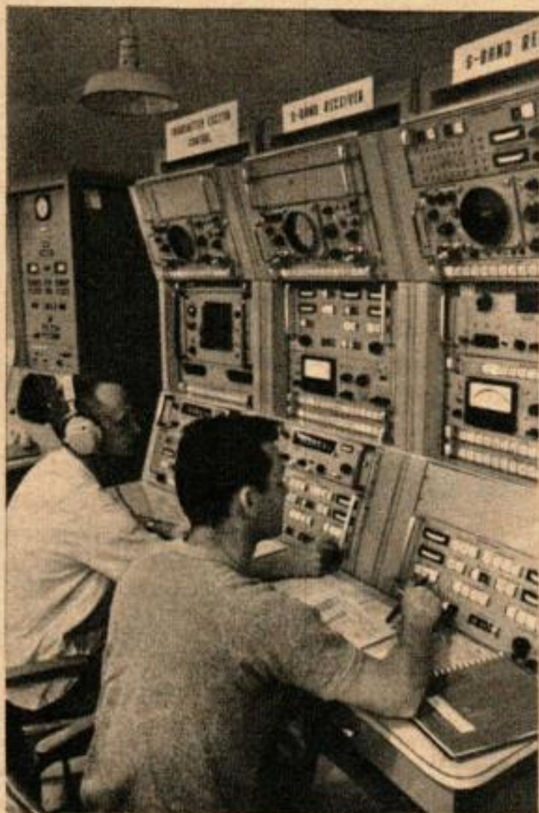
UN APPAREILLAGE ELECTRONIQUE COMPLEXE couvre les murs de la « salle des machines », sous l'antenne. Les commandes pointent avec précision la coupe de 9 000 t vers les cibles lointaines.
