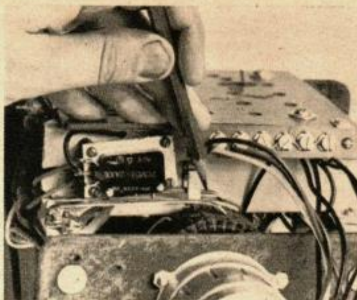
UN ERGOT DE COMMANDE montré par le crayon ferme le contact S3 en se déplaçant sur un trombone porté par la piste d'appel du tambour enregistreur. Au-dessus de l'autre ergot, on voit la tige coulissante de S2.
