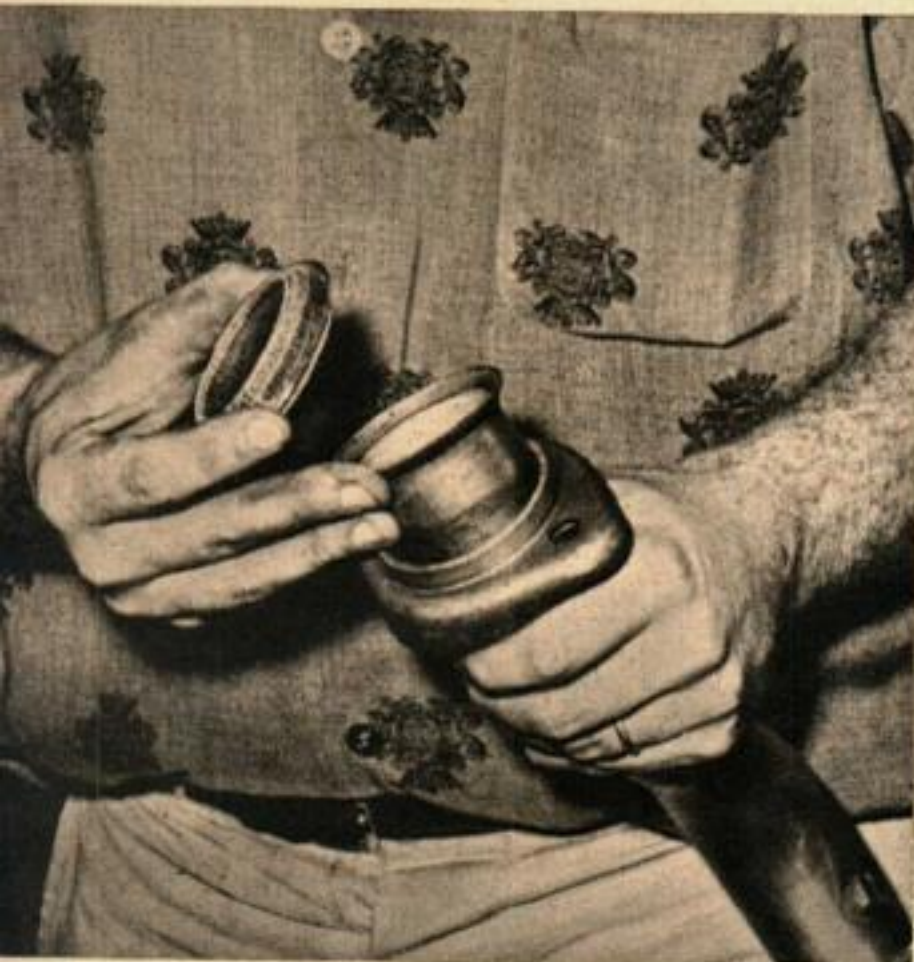
ON OUBLIE SOUVENT les collerettes du tuyau d'échappement sur tubulure. La présence d'une poudre blanche autour du joint indique une mauvaise garniture ou des boulons desserrés.
