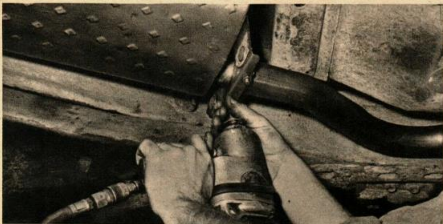
A CHAQUE INSPECTION et à chaque changement d'un élément, toutes les brides et toutes les fixations doivent être serrées pour empêcher les chocs entre pièces. On voit un tuyau de sortie de Chevrolet avec une fixation qui joue aussi le rôle de bride.
