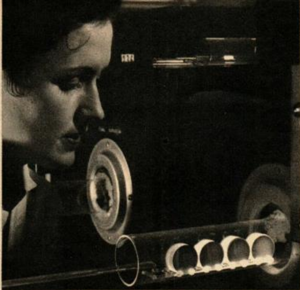
UN PLATEAU DE PLAQUETTES DE SILICIUM est glissé dans le four, dans l'usine des microcircuits de la General Electric. C'est là que se forme la couche d'oxyde. Durant ces premières phases de la fabrication, on manipule un grand nombre de plaquettes à la fois ; ensuite on les sépare pour les opérations de gravure et de dopage.
