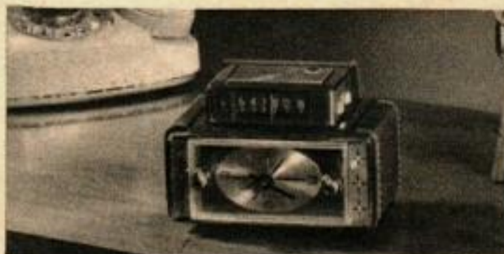
LA PREMIERE UTILISATION est cette pendulette radio de la GE. Tout l'amplificateur tient sur un module que l'on peut enlever.
