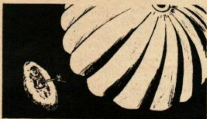
LE PARACHUTE MOOSE s'ouvre automatiquement à l'altitude voulue et fait descendre doucement l'astronaute.
