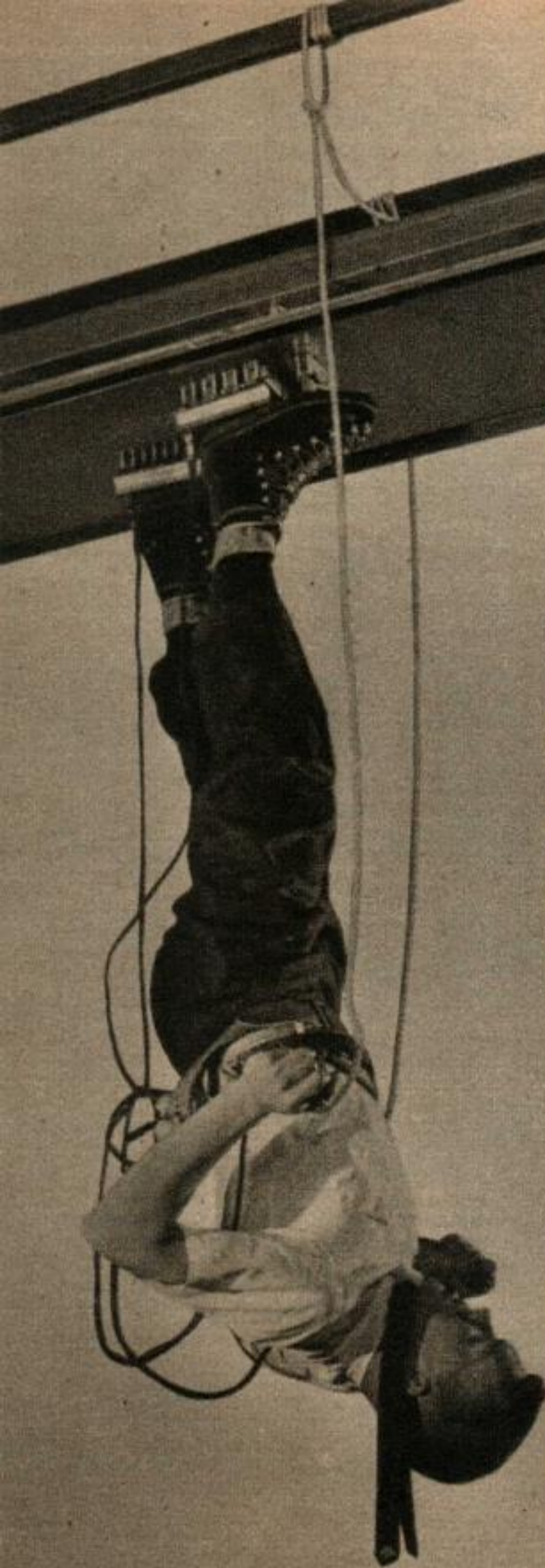
UN TOUR D'ACROBATIE AVEC DES CHAUS- SURES MAGNETIQUES. Les aimants sont permanents, mais on peut les neutraliser avec une bobine parcourue par un courant électrique et libérer ainsi les pieds l'un après l'autre.
