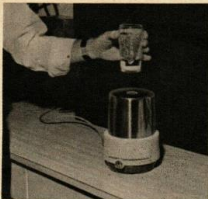
L'AIMANT QUI TOURNE DANS L'APPAREIL a un champ si puissant qu'il fait tourner la plaque métallique mélangeuse dans le verre tenu à 10 cm au-dessus. Cet appareil peut servir à toutes sortes d'usages dans la cuisine.
