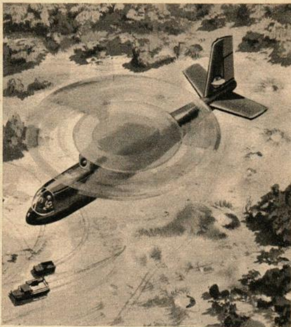
Avion-hélicoptère révolutionnaire de la Hughes Aircraft. Il possède une voilure en forme de triangle. Quand celui-ci tourne, l'aéronef est un hélicoptère. Quand il est fixé en position stable, il fait office d'ail. L'aéronef devient alors avion, avec une vitesse de pointe qui frise les 800 km/h.
