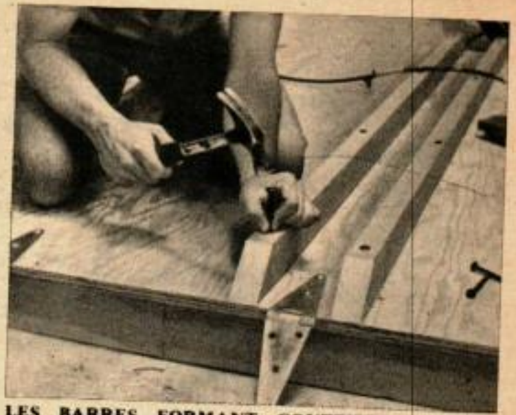
LES BARRES FORMANT GOUTTIERE pour les roues sont boulonnées sur la plate-forme en contreplaqué avec des boulons d'assemblage avant de fixer les parois.
