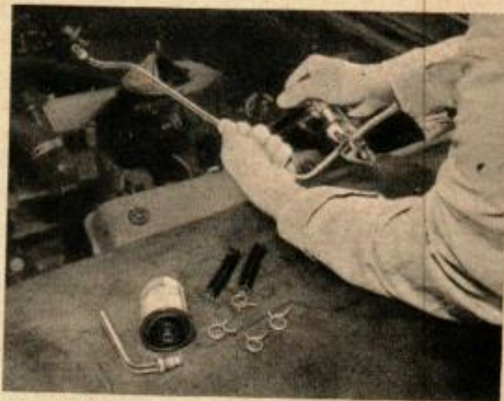
DETACHER LA CANALISATION D'ESSENCE et la couper dans une section relativement droite en enlevant 90 mm de tube.
