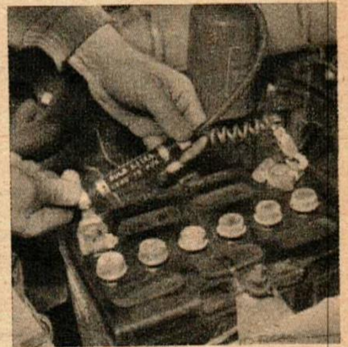
VERIFIER LA POLARITE de la batterie avec le contrôleur. Avec la pince sur la borne positive, et l'étui sur la borne négative, l'ampoule s'allume.
