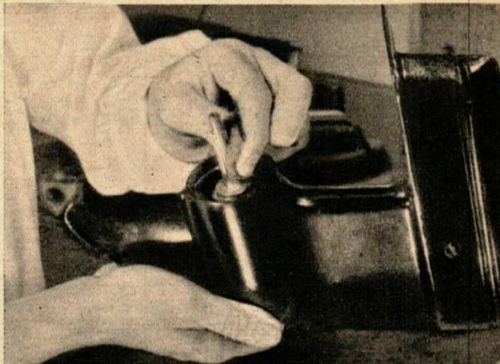
PASSEZ UNE FINE COUCHE DE GRAISSE graphitée ou aux silicones sur l'arbre avant de remettre l'hélice.
