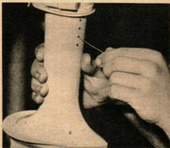
SI LES TROUS DU BLOC INFÉRIEUR sont bouchés, vous les nettoyez avec un fil de fer.
