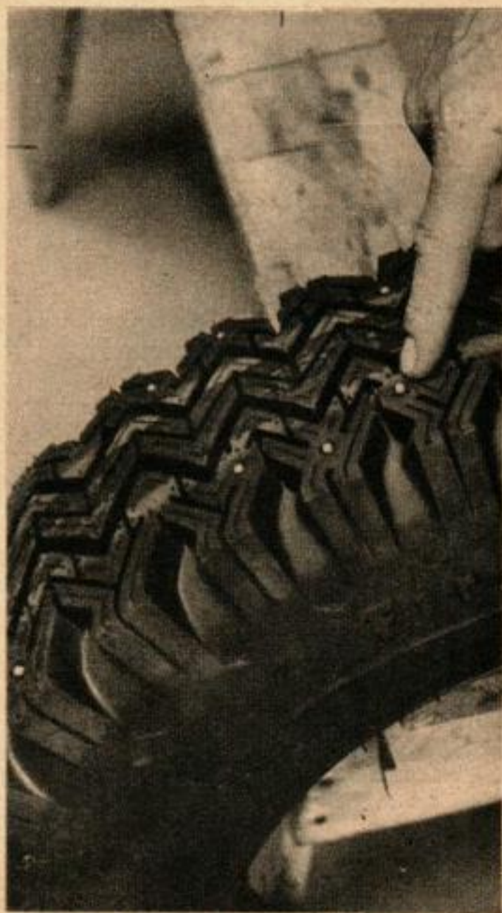
LES ERGOTS SONT DISTRIBUES irrégulièrement pour éviter la résonance. Les ergots en porcelaine font moins saillie que les autres mais d'après les ingénieurs de Coors cela ne nuit pas à leur action.
