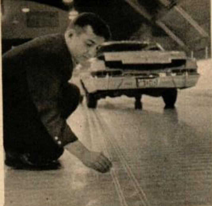
LES SILLONS LAISSÉS PAR LES ERGOTS sur la glace après les essais de freinage sont faciles à identifier. Les pneus de neige sans ergots laissent des traces de sculpture qui permettent de faire des mesures précises.
