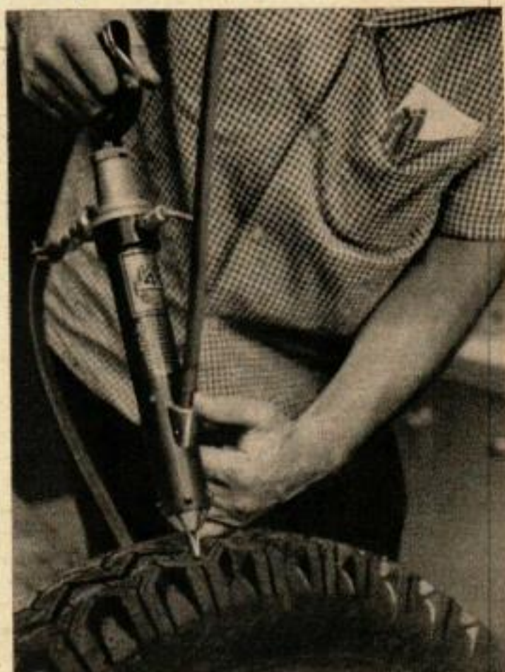
LES « DOIGTS » DE CALAGE du pistolet à air comprimé agrandissent le trou de la bande du pneu pour y enfoncer la cheville la tête la première.
