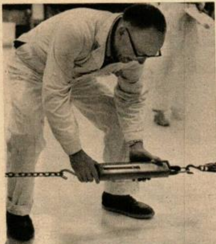
UN DYNAMOMETRE DE 230 KG DE PUISSANCE relie les deux véhicules pour permettre la comparaison entre les effets de traction des pneus de verglas ordinaires et de ceux qui ont des crampons.
