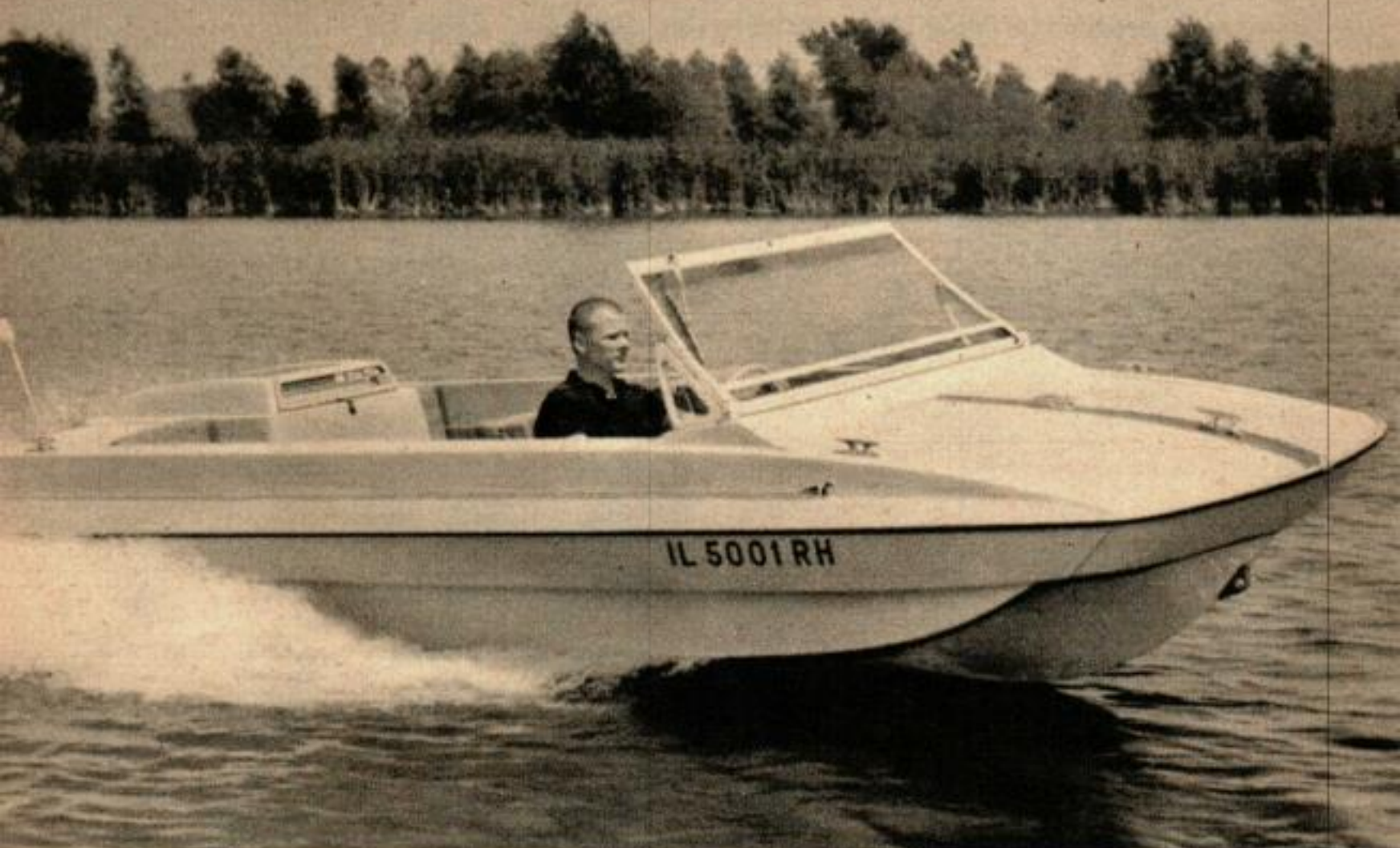
LA COQUE TRIEDRE déjauge facilement, passe bien sur le clapotis et gîte à peine dans les virages.
