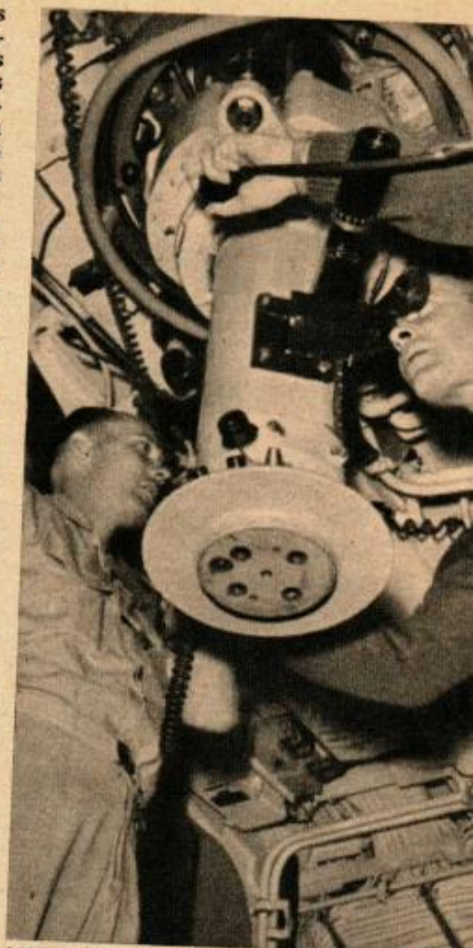
L'OFFICIER D'OBSERVATION manœuvre le périscope tandis que le sous-marin navigue à faible profondeur. On peut aussi repérer le but avec Sonar, sans se servir du périscope.
