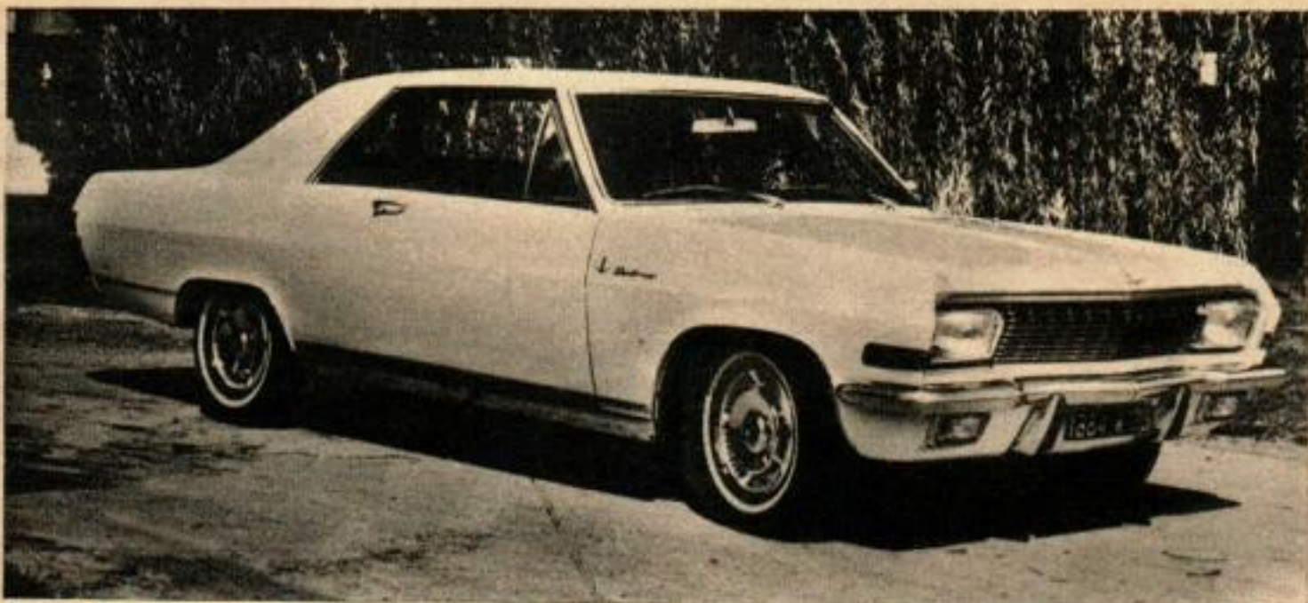
Le coupé « Diplomat », équipé d'un moteur V 8 de 5,4 litres, a une vitesse maximum de 206 km/h avec des accélérations de 0 à 100 km/h en 9,5 secondes.
