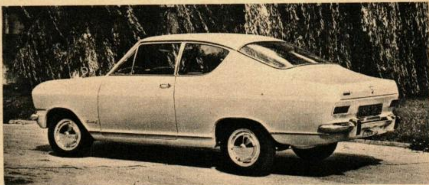
Le coupé Opel « Kadett » est équipé du moteur super de 1.1 litre développant 59 CV, d'une transmission sport, de freins à disques à l'avant et de pneus de 13 pouces.
