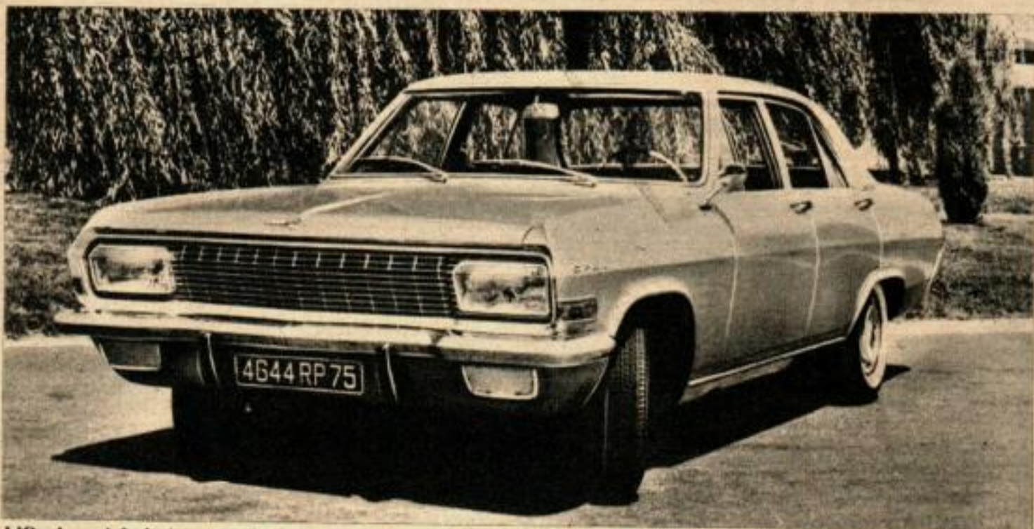
L'Opel « Admiral » est équipée du moteur 6 cylindres de 2,8 litres développant 140 CV à 5 200 t/mn.
