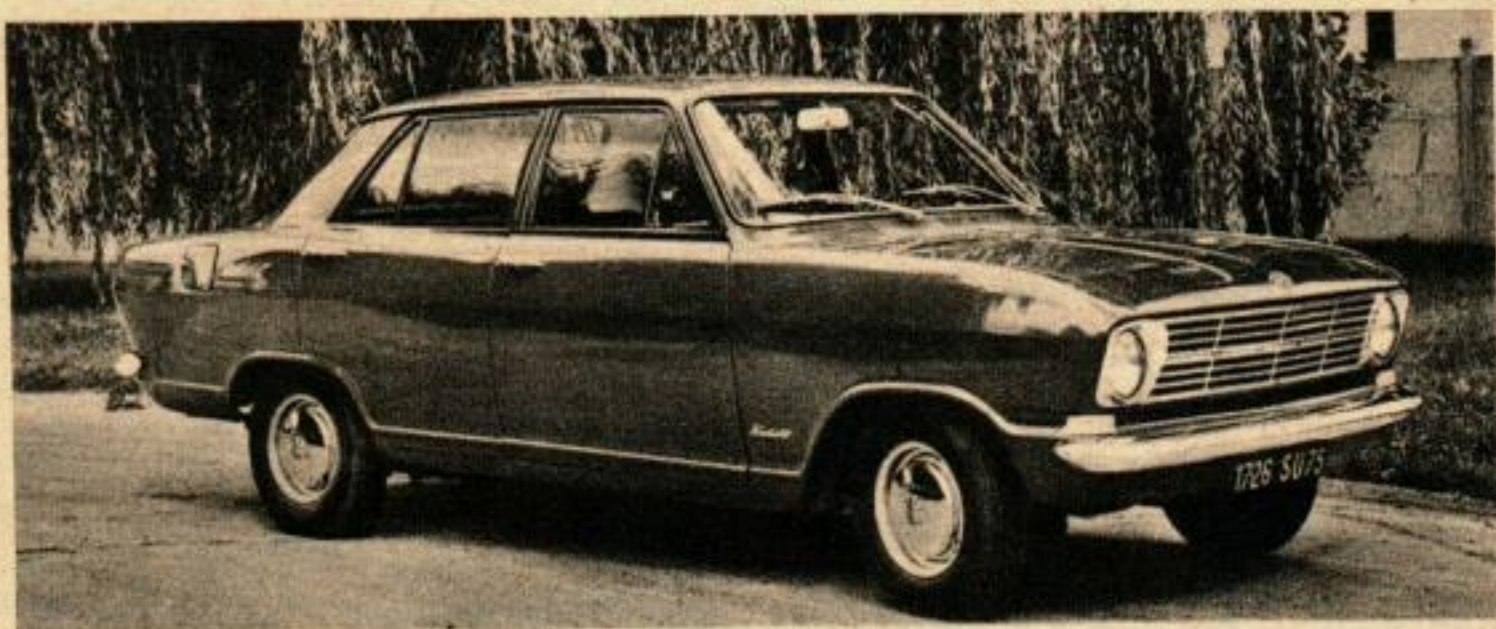
L'Opel « Kadett » 4 portes est offerte en trois versions : normale, luxe, et luxe super. Les deux premières sont équipées d'un moteur quatre cylindres de 54 CV ayant un taux de compression de 7,8 à 1. La version luxe super est mue par un moteur 59 CV, également quatre cylindres, ayant un taux de compression de 8,8 à 1. La consommation est de l'ordre de 7,5 litres aux 100 km.
