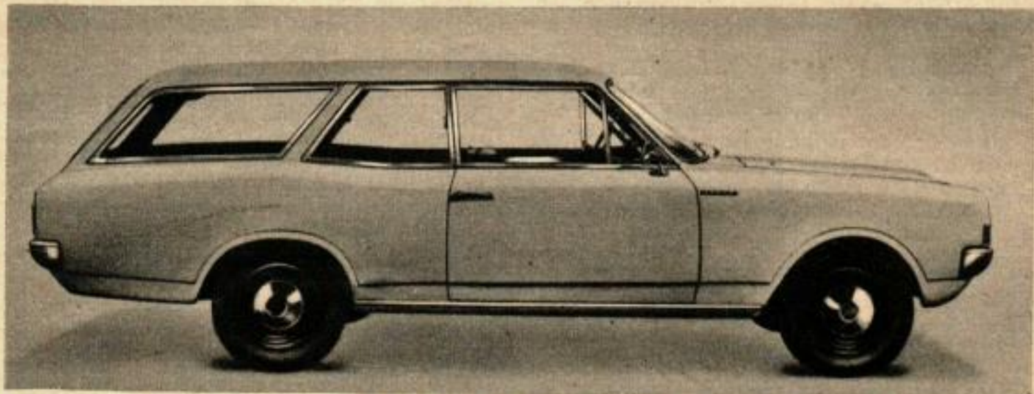
La nouvelle Opel « Rekord Caravan » a une charge utile de 500 kg. Avec le dossier du siège arrière rabattu, l'espace de chargement est de 1,82 m de longueur. La « Rekord Caravan » 5 places peut être équipée soit avec les moteurs 4 cylindres 1,5 litre, 1,7 litre, 1,9 litre, soit avec le nouveau moteur 6 cylindres 2,2 litres.
