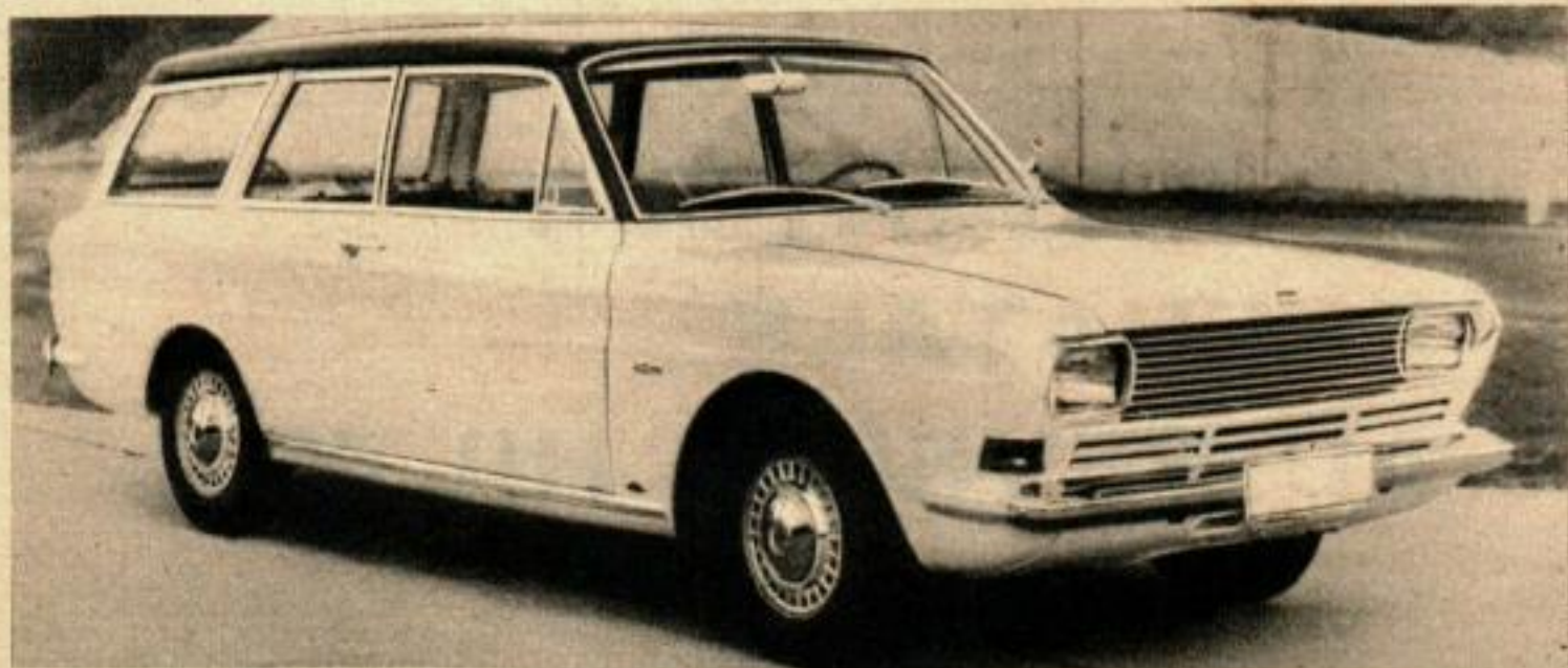
Le break « Taunus » 1967 de Ford possède des dimensions intérieures considérables. Avec la banquette arrière couchée, il y a 1,65 m de longueur disponible. Sa charge utile atteint 420 kg. La longueur hors tout est de 4,32 m.
