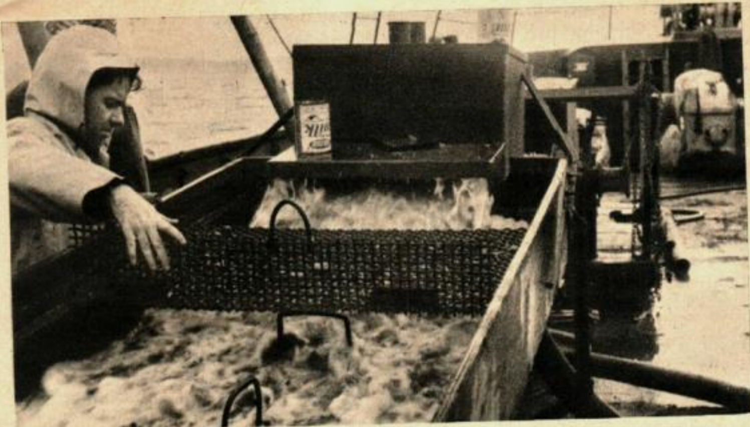
Sur la rampe de lavage, toutes les matières légères sont emportées par le courant et les matières lourdes restent.
