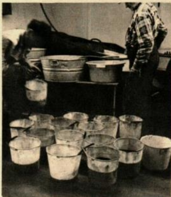
LES ECHANTILLONS prélevés sur le fond de la mer sont placés dans des bassines, puis chaque bassine est passée à la batte pour déterminer si un certain endroit mérite d'être prospecté à fond.
