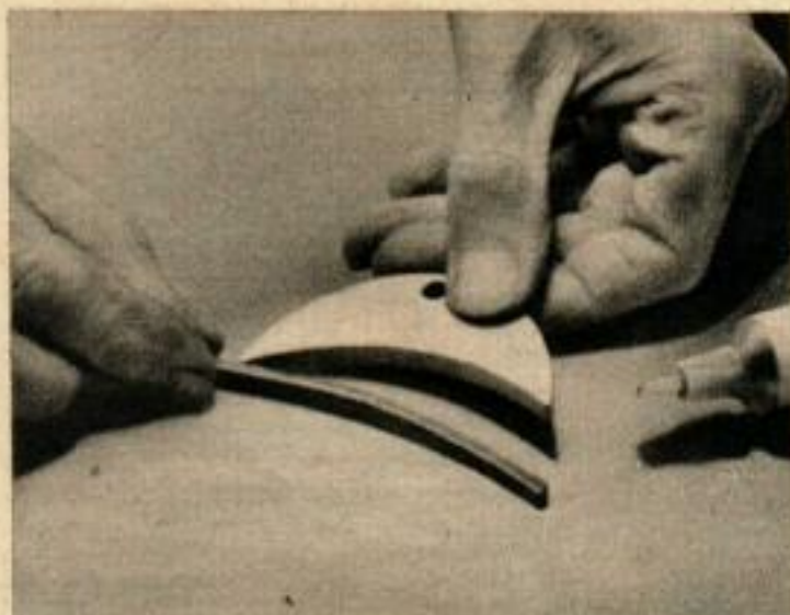
LA GARNITURE EN CUIR est collée sur le bord du sabot de frein qui est taillé pour s'appliquer sur la courbe de la poulie. Le bord est rendu rugueux et couvert de Pliobond.
