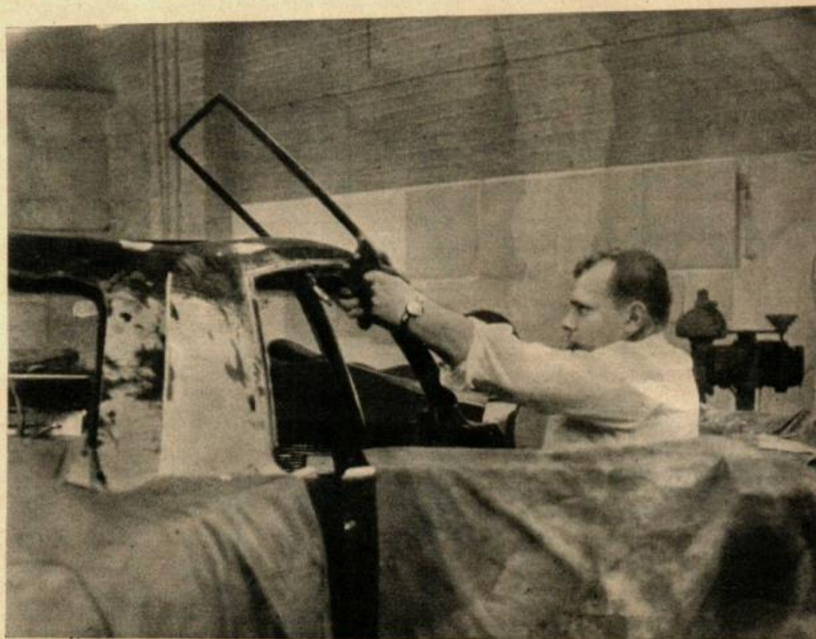
LA VOITURE EST SCIEE EN DEUX, juste en arrière des montants de porte, après déshabillage de l'intérieur et démontage du toit.
