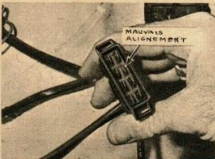
VOUS CONSTATEZ QU'UNE BORNE est tordue en la comparant aux autres ; redressez-la.
