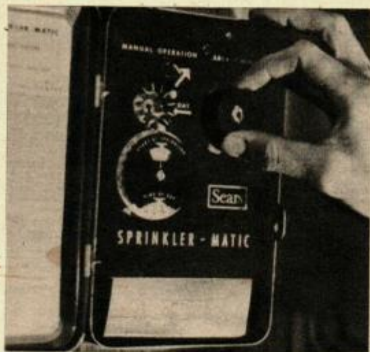
UNE COMMANDE ELECTRIQUE ouvre et ferme automatiquement les mécanismes de valve à basse tension, à des intervalles réglés d'avance. La commande est alimentée sous 110-120 volts.
