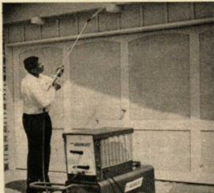
ON OBTIENT DES PROJECTIONS de formes diverses avec l'Aquablast en glissant des disques dans le chalumeau de l'appareil. On peut également utiliser ce dernier pour laver les voitures, les clôtures, les bâtiments.
