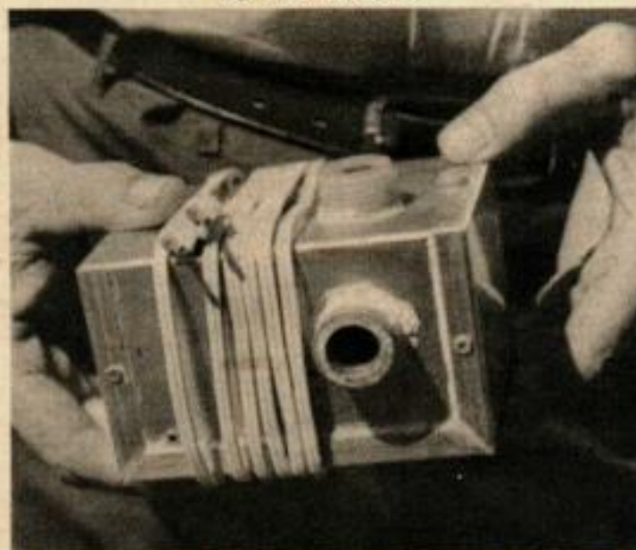
L'APPAREIL DE COMMANDE du « Mist Master ». On y voit la connexion électrique, les entrées d'eau et le diffuseur.
