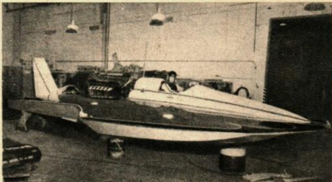
ON INSTALLE LE GROS MOTEUR ROLLS ; il sera recouvert par le capot.
