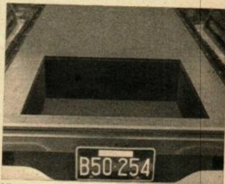
LE PLANCHER de la camionnette entre les alvéoles des roues est remplacé par du contreplaqué extérieur qui est vissé (et non collé) sur l'encadrement de la cuvette. Cela renforce la cuvette et protège l'intérieur contre la poussière.
