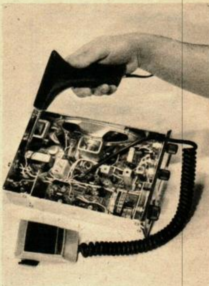
Cet émetteur-récepteur de grande puissance pour communications particulières forme un ensemble peu encombrant. Les 23 canaux sont mis en circuit par sélecteur. Un circuit de contre-réaction réduit le bruit de fond.
