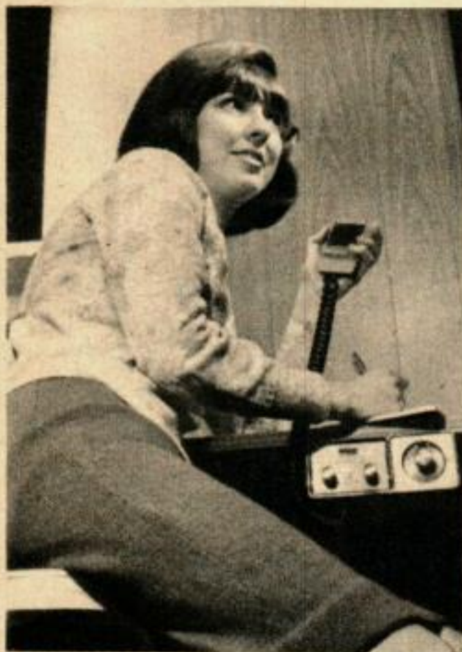
Cet émetteur-récepteur de grande puissance pour communications particulières forme un ensemble peu encombrant. Les 23 canaux sont mis en circuit par sélecteur. Un circuit de contre-réaction réduit le bruit de fond.
