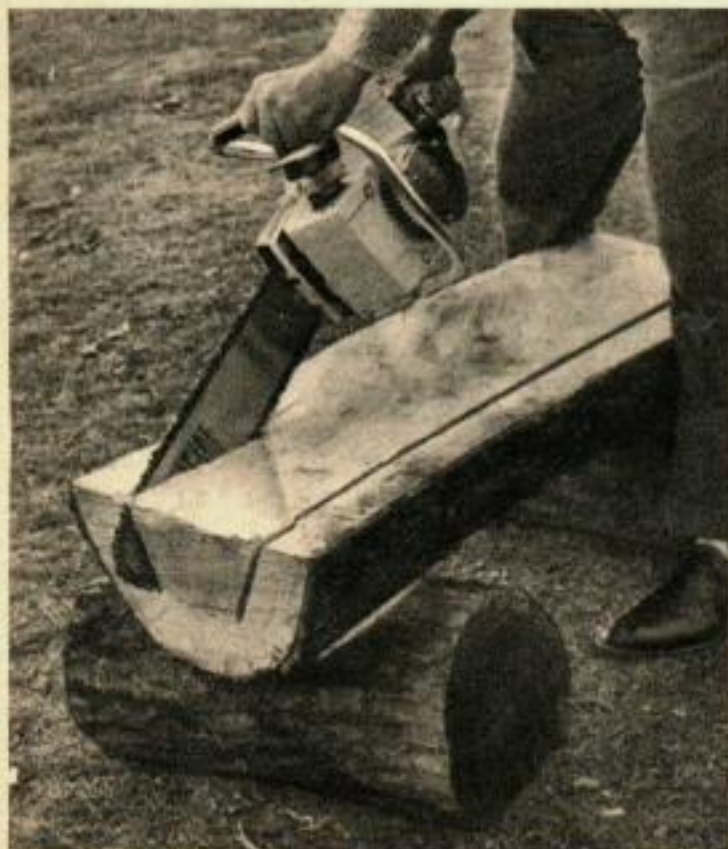
DANS UNE BILLE COUPEE EN DEUX, on exécute deux coupes parallèles inclinées vers l'intérieur, à la profondeur voulue.
