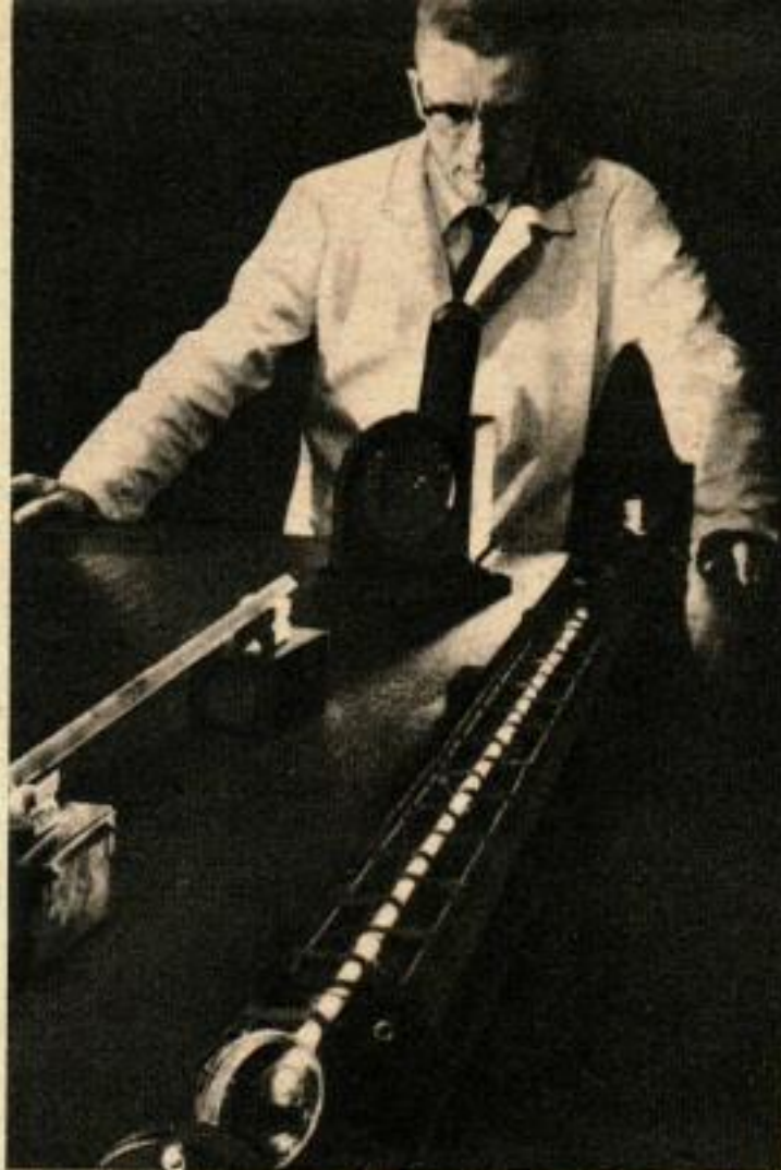
Sur notre photo, une tige de verre pour laser Kodak à base de nityrodine est testée au moyen d'un interféromètre à laser à gaz.
