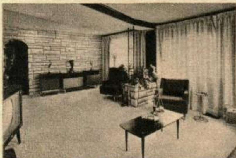
UN PARFAIT REALISME est atteint par l'adjonction de véritable pierre broyée dans ces plaques de 30 x 120 cm; on voit ci-dessus un exemple d'un tel mur de « pierres ».
