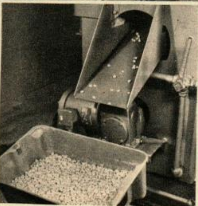
A L'INTERIEUR DU FUT, de petits objets métalliques sont « martelés » par de petites boules de verre secouées jusqu'au moment où la surface est matée. On appelle ce procédé placage par matage.
