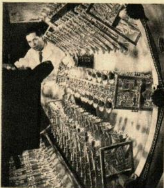
LA METALLISATION DE JOUETS est réalisée en chambre à vide. Le matériau de couverture est porté à l'état gazeux par la chaleur et se dépose atome par atome sur la surface de ces trompettes.
