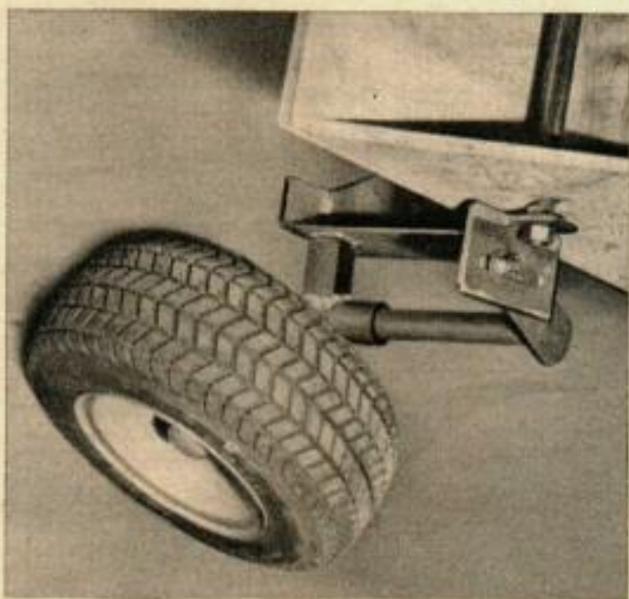
LE PORTE ROUE , qui fait partie de l'ensemble, est monté sur la plate-forme en contreplaqué et encastré dans le flotteur.
