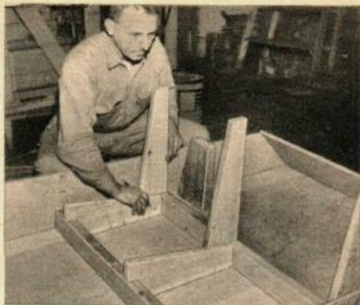
LA CHARPENTE DU SIEGE constitue la membrure centrale du véhicule. Pour plus de solidité, on prend des barres de 5x10 cm.
