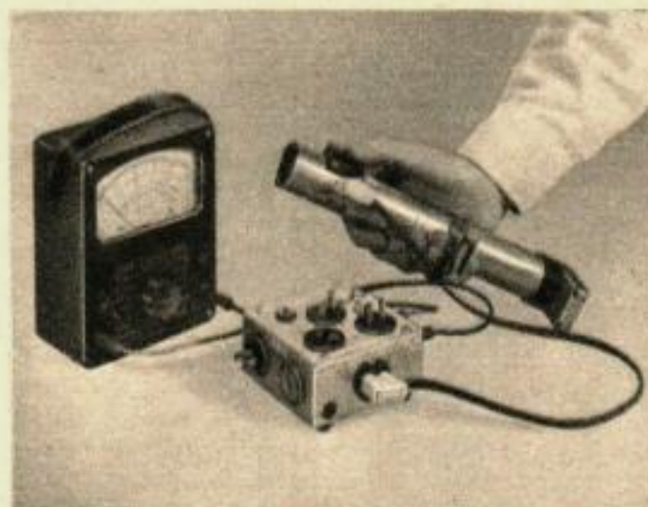
LA BOÎTE ADAPTATRICE, couplée au VOM, sert à vérifier l'état des piles en tous genres.
