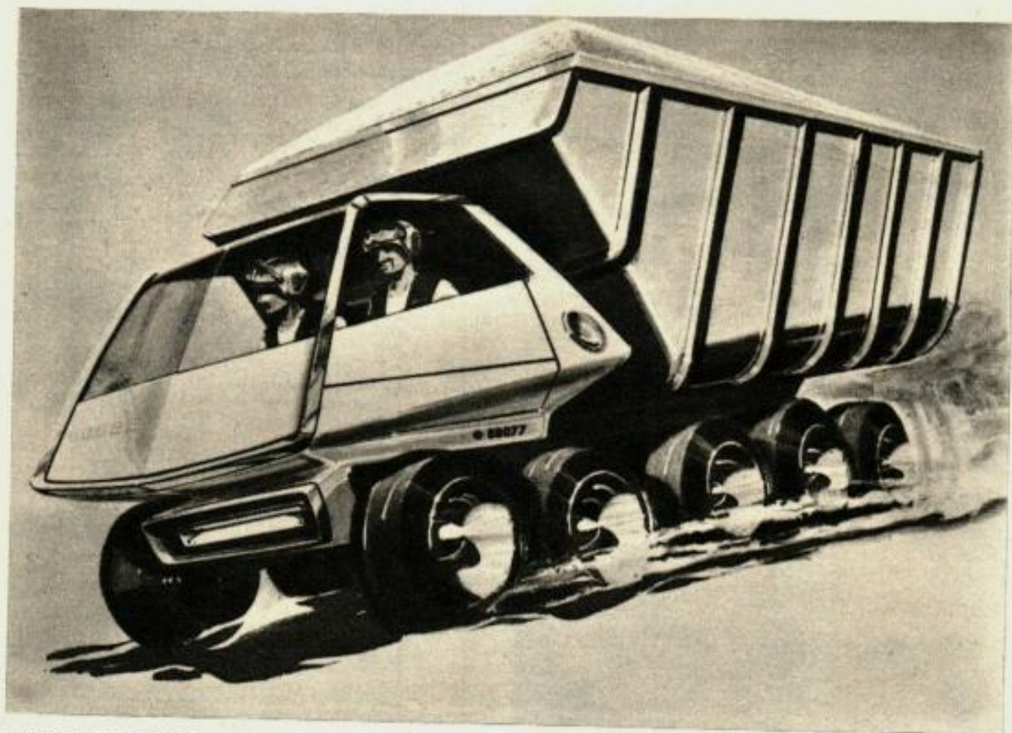
VOICI UN CAMION DE 1970 vu par Dodge. Ses dix pneus triple largeur lui permettront de traverser le sable, les secteurs marécageux et les fleuves.
