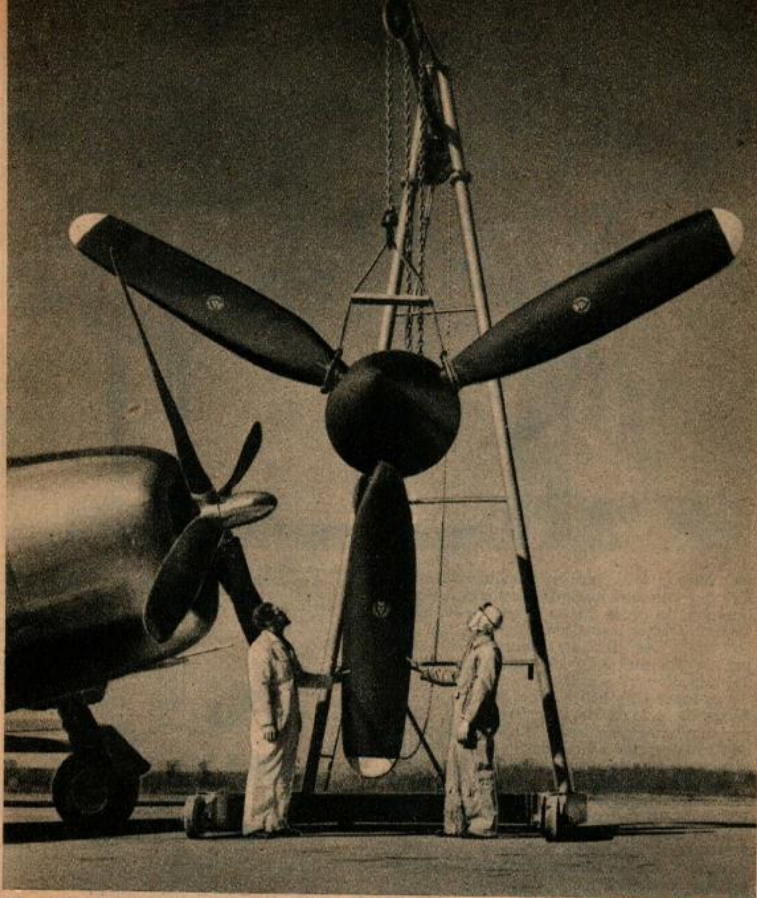
L'heure n'est pas encore venue de dire adieu à l'hélice. Le plus grand appareil terrestre du monde, le XC-99 est muni de 6 de ces hélices de 6 m. À l'atterrissage l'inclinaison des pales peut être inversée pour freiner la course au sol.
