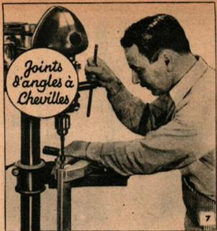
Percer les trous d'abord dans la tranche, en les espaçant à l'œil.
