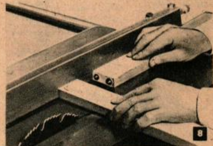
Ci-dessus, situer l'emplacement des trous avec les pointes de centrage pour chevilles. Ci-dessous, percer les trous latéraux en maintenant la pièce contre le bloc.
