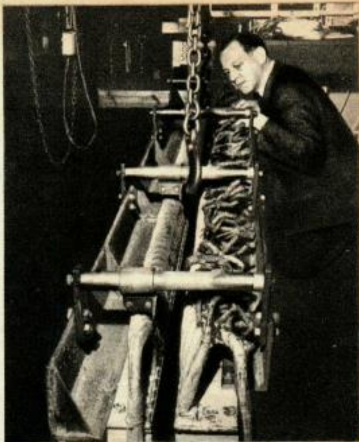
2. LE PROFESSEUR LAITHWAITE est ici à côté d'un modèle plus grand du moteur linéaire, construit dans son laboratoire, et capable de propulser un autorail complètement chargé à plus de 100 km/h. C'est un moteur de 400 CV, qui est à double face pour avoir un rendement encore plus grand. La « lame » passe au milieu des bobines, comme sur la version plus petite.
