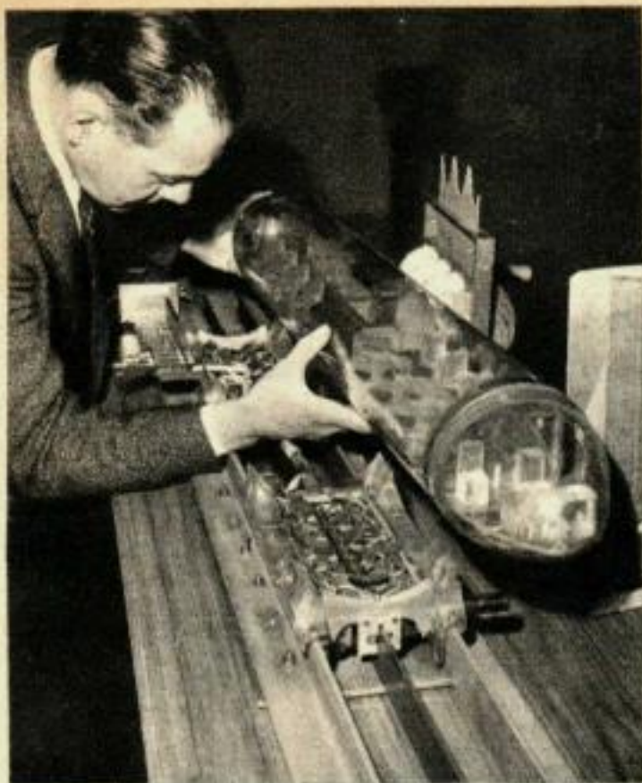
1. DANS SON LABORATOIRE de l'Université de Londres, le professeur Laithwaite fait une démonstration de son modèle de train de l'avenir, propulsé par un moteur linéaire. Il a enlevé la carrosserie de l'autorail du châssis pour faire voir les bobines d'induction linéaires. Passant entre les bobines, au milieu de la « voie », se trouve l'autre moitié du moteur — la lame métallique de métal noir qui réagit sur les bobines du train pour faire avancer ce dernier.
