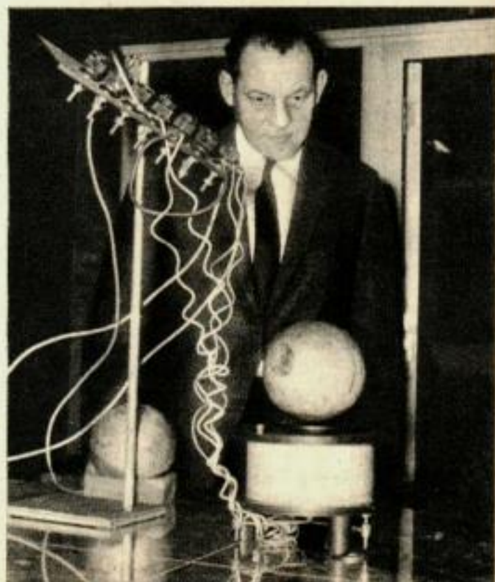
4. VOICI UNE APPLICATION PEU HABITUELLE du principe du moteur linéaire, appelée un « Levitator ». On voit un disque métallique rester en suspension sans aucun appui matériel au-dessus d'un champ électromagnétique puissant. Cela peut avoir certaines applications industrielles pour la commande à distance. La plaque pourrait en réalité porter un homme à quelques centimètres au-dessus des bobines à champ circulaire.
