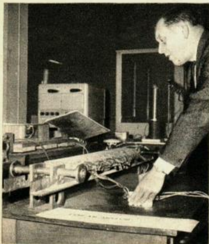
3. ON VOIT ICI UN MOTEUR LINEAIRE sous sa forme la plus simple, au moment où il projette une plaque métallique loin de la base du moteur. Dans la pratique, la plaque est fixe et le moteur est mobile, monté en dessous d'un train. Quand on applique le courant, le moteur se « projette » lui-même loin de la plaque, déplaçant le train avec lui.
