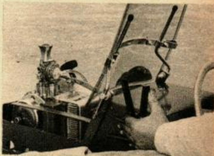
L'ACCELERATEUR A MAIN a un dispositif de sécurité. Il faut le pousser en avant pour faire marcher le moteur. Si on le lâche, le moteur s'arrête automatiquement.
