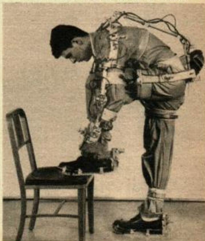
L'EXOSQUELETTE, manœuvré à l'aide de l'électricité musculaire, triple la force d'un homme.
