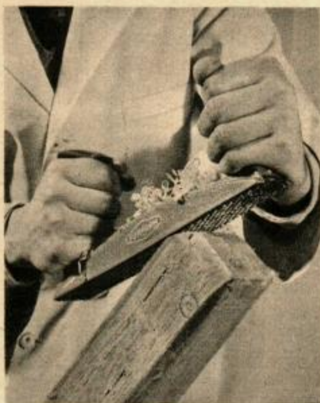
Voici le rabot Surform avec poignée et bouton. Les nombreuses petites lames de la plaque métallique perforée arrondissent vite les coins de bois.
