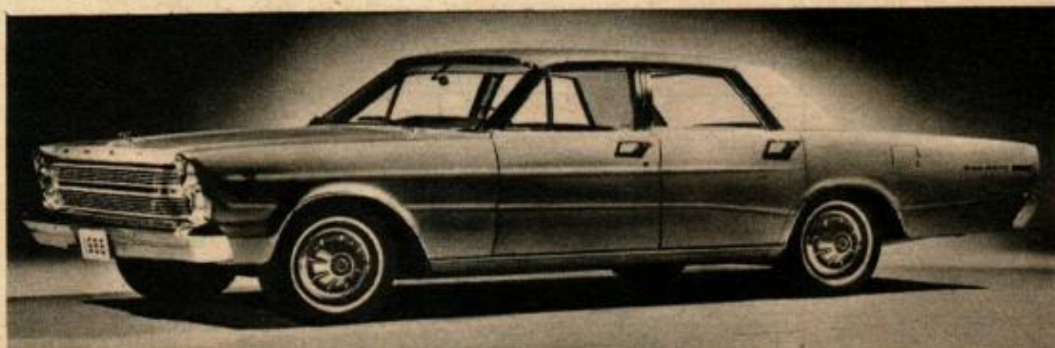
Ici, le petit-fils du modèle « T ». C'est la Ford « Galaxie », voiture effilée, puissante, confortable. Longueur hors-tout : 5,33 m ; moteur : 8 cylindres en V ; soupapes en tête ; carburateur 4 corps inversé ; puissance : 300 CV ; cylindrée : 6 391 cm 3 . La direction, les freins, les glaces et les sièges sont assistés ; la boîte, bien entendu, est automatique. En ce qui concerne la vitesse, Ford ne met pas d'accent là-dessus, mais on dit que vous aurez rarement besoin de plaquer l'accélérateur contre le plancher.
