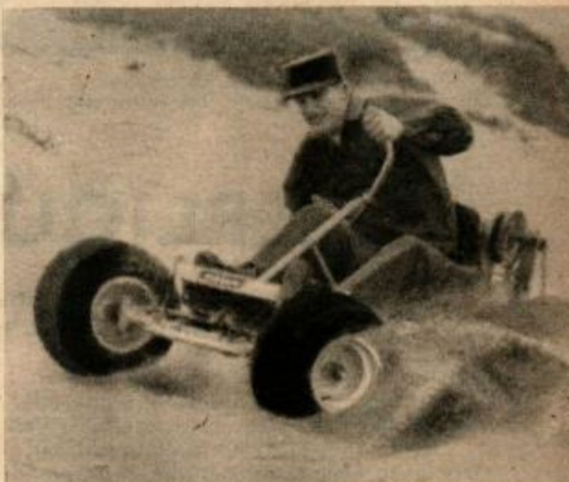
LE GUIDON TRES EFFICACE et le moteur arrière permettent les virages serrés ; le châssis bas et large, ainsi que les pneus, donnent une grande stabilité.
