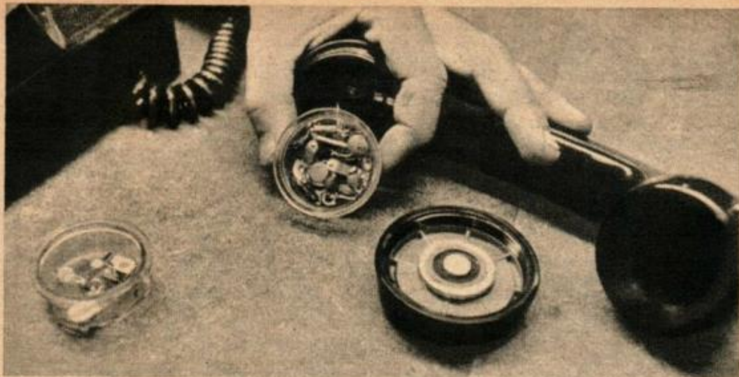
UN ESPION PEUT ETRE installé dans le micro de votre téléphone. Il se met à la place de l'alvéole plastique (qu'on voit à droite) dans laquelle s'encastre le micro ordinaire.
