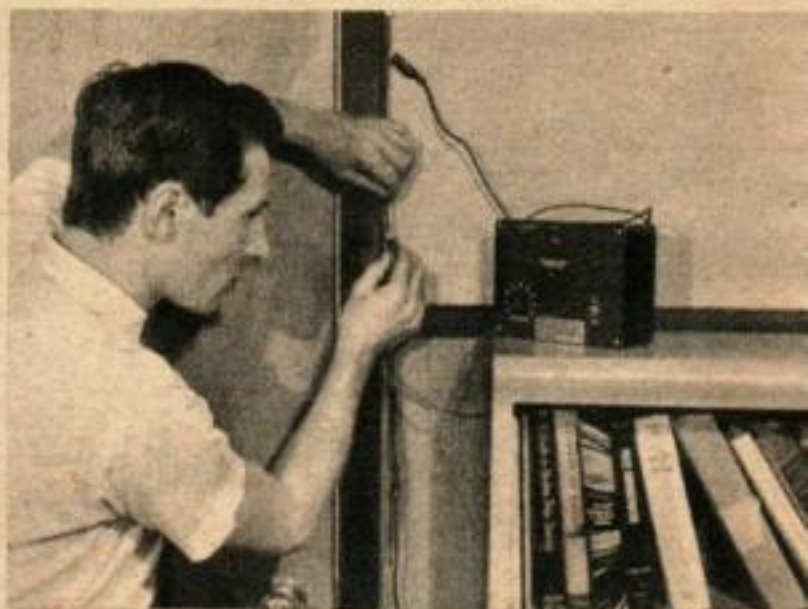
OU PEUT CHERCHER les micros cachés avec une hétérodyne. On voit ici, Bill Eaton à l'œuvre. L'appareil transforme le micro en haut-parleur produisant des sons audibles.
