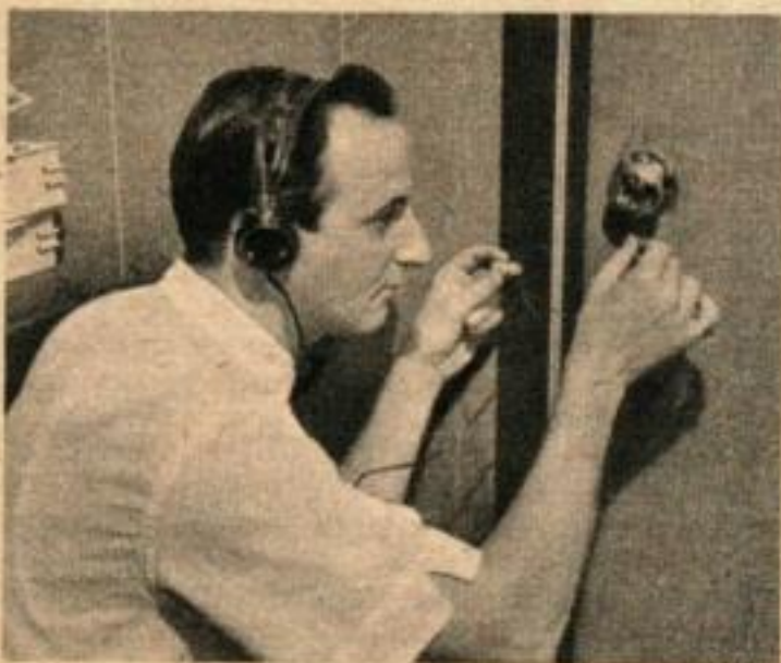
UN MICRO DANS LE TROU DE LA SERRURE, démonstration de Sirchie, est un excellent moyen pour écouter ce qui se dit derrière une porte hermétiquement fermée.
