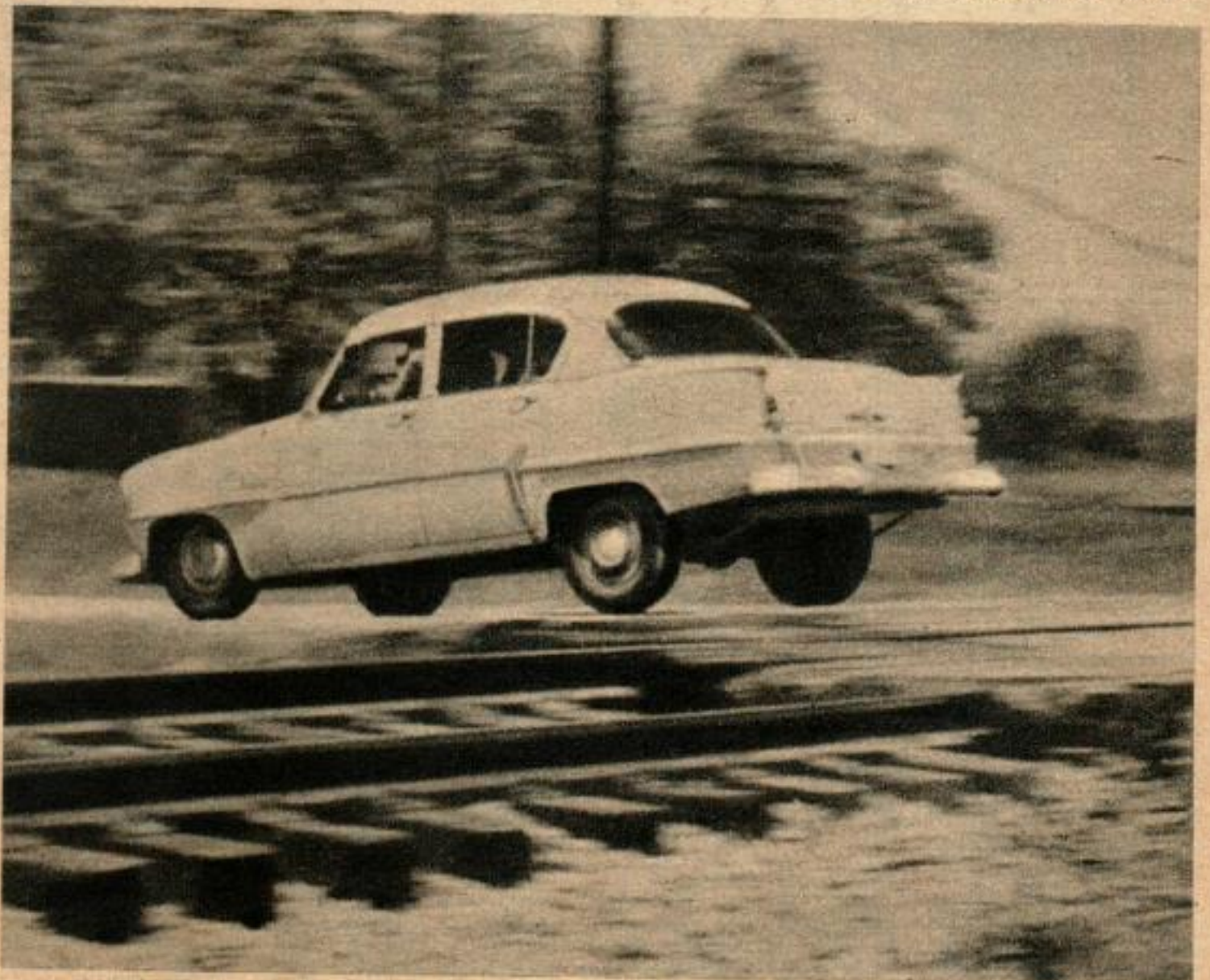
UN BON EXEMPLE DE MAUVAIS AMORTISSEURS , c'est le rebondissement de l'extrémité arrière de cette voiture lorsqu'elle traverse une voie ferrée.
