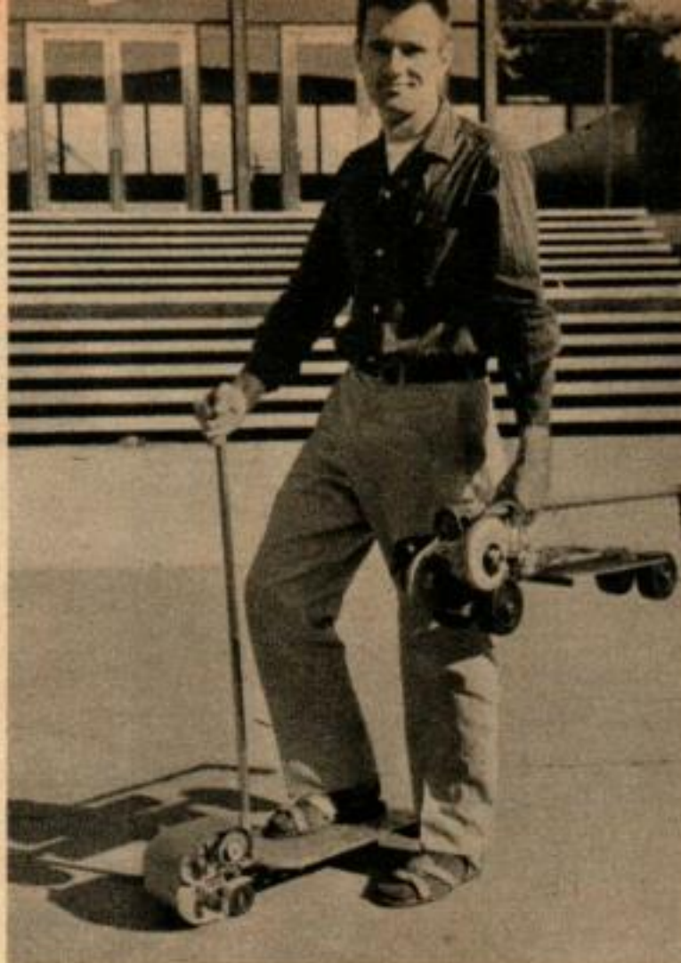
LE SKEETER est un exemple de très petit véhicule individuel. On le manœuvre avec le poids du corps. Il est équipé d'un moteur industriel de 1/2 CV. La vitesse maximale est de 30 km/h. Le guidon de la trottinette qui pèse 8 kg se replie pour le transport.
