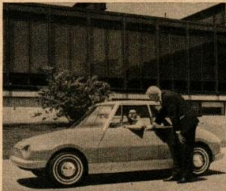
CETTE AUTO A 4 PLACES est équipée d'un moteur Toyota deux cylindres, avec traction avant. Les passagers assis à l'arrière font face vers l'arrière. Cette voiture est de presque 60 cm plus courte que la VW.
