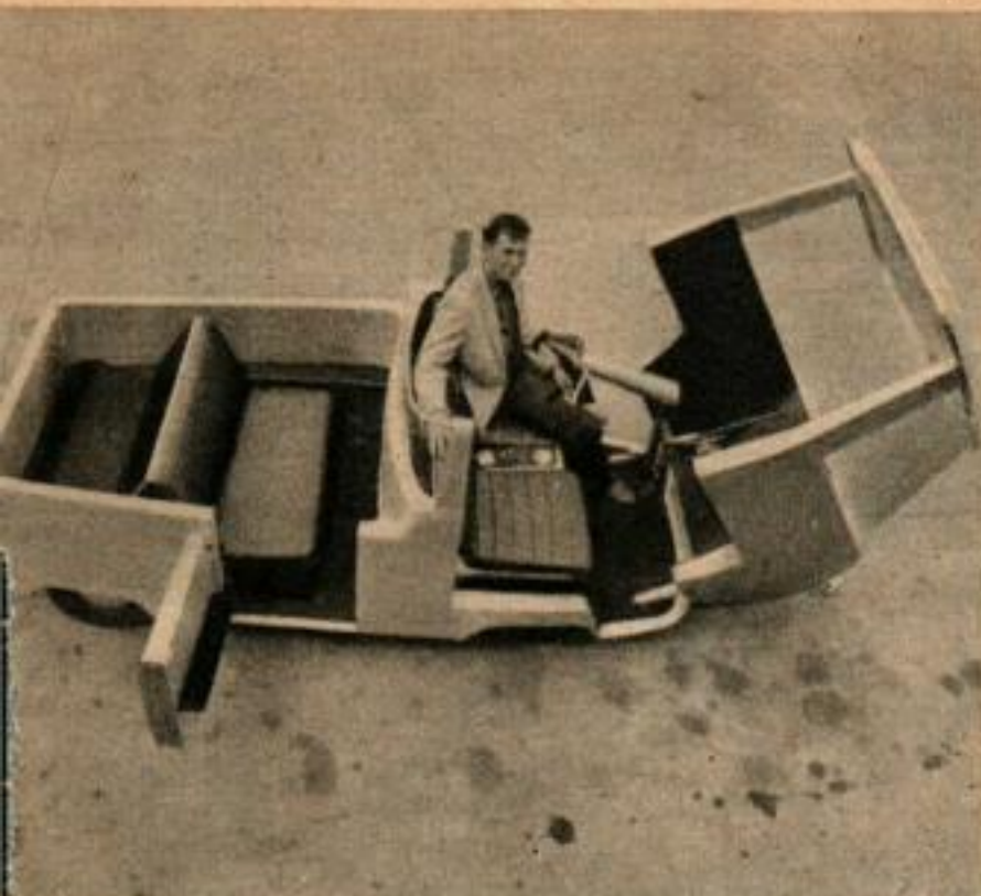
LA CABINE DE LA SPARKY s'ouvre comme une coquille d'huître pour donner accès au conducteur. La plate-forme arrière a un siège rabattable pour les passagers. Le véhicule pèse 450 kg.
