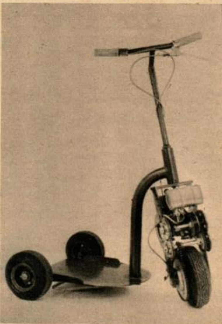
LA TROTTINETTE a un guidon qui peut tourner complètement sur lui-même, ce qui permet de faire marche arrière sans changer de vitesse. Ce véhicule peut faire 40 km/h et passer sur des terrains accidentés grâce à ses roues.
